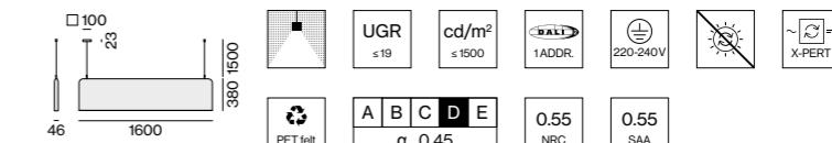
SYS. POWER 20W COLOUR TEMP. 3000K 4000K LUM. FLUX 2080lm 2200lm L (mm) 1600 ORDER CODE 0 9 1 - 1 2 1 1 :: 3 F
